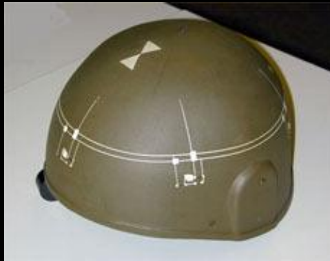
Каска с нанесенной с помощью технологии "direct-write" антенной (BAE systems)
