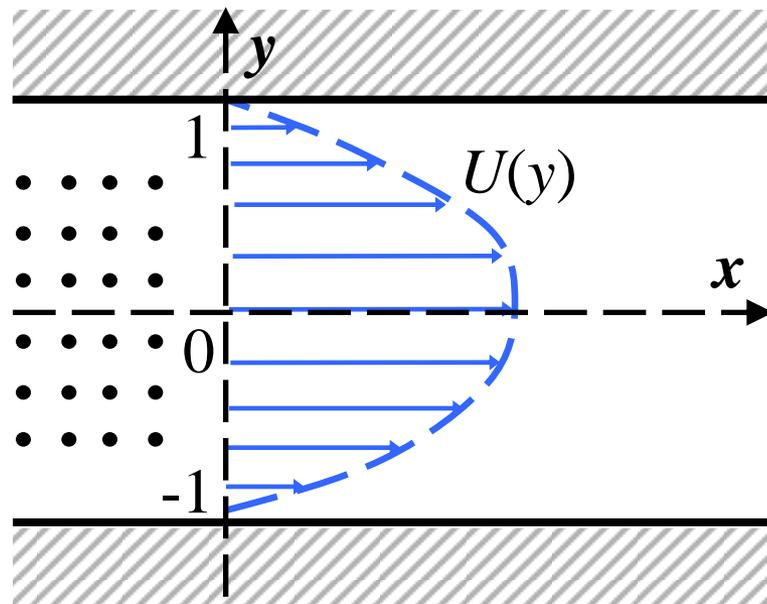
Плоское течение Пуазейля суспензии
