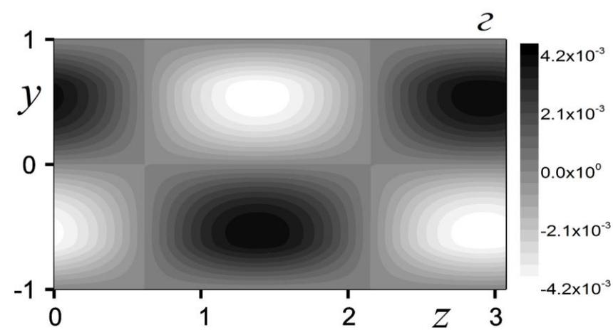
Распределение продольной компоненты скорости оптимальных возмущений несущей фазы  $u$  в плоскости  $(y, z)$  при  $t = 0$  ( $a, b$ ) и в момент достижения максимума плотности энергии ( $b, z$ ). Фигуры ( $a, b$ ) соответствуют  $\xi = 0.25$ , а ( $b, z$ ) –  $\xi = 0.65$ .  $k_x = 0, k_z = 2.044, Re = 5000, \alpha = 0.2, \beta = 10, \delta = 0.02$ .
