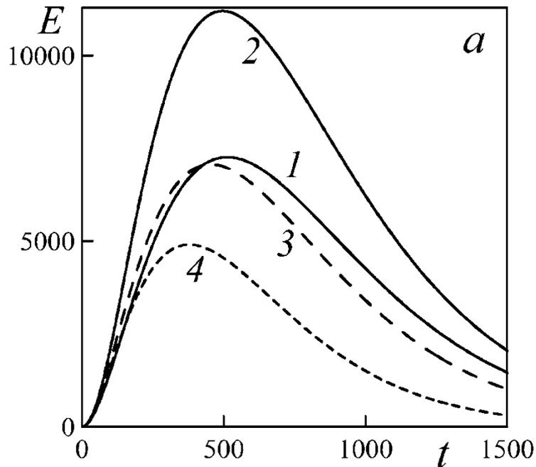
Зависимость энергии оптимальных возмущений  $E$  от времени. Кривые 1, 2 соответствуют  $\xi = 0.25, 0.65$ , а 3 – однородное распределение частиц, 4 – чистая жидкость.  $k_x = 0, k_z = 2.044, \text{Re} = 5000, \alpha = 0.2, \beta = 10, \delta = 0.02$
