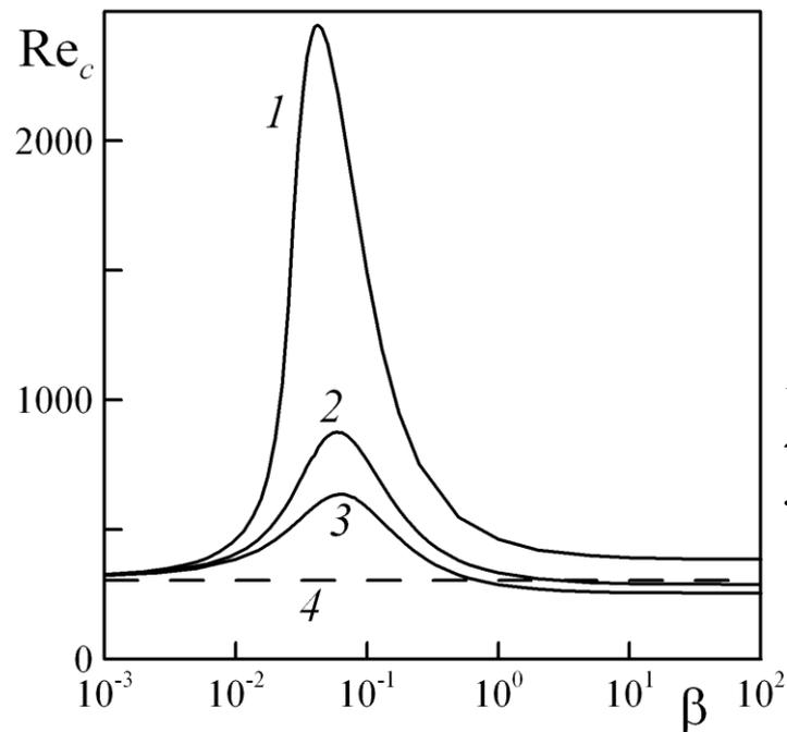
Зависимость критического числа Рейнольдса  $Re_c$  от массовой концентрации включений  $\alpha$ .
